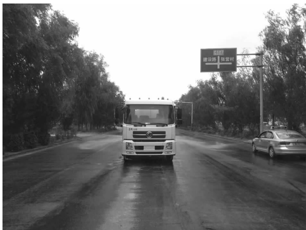
洒水防治公路扬尘污染
